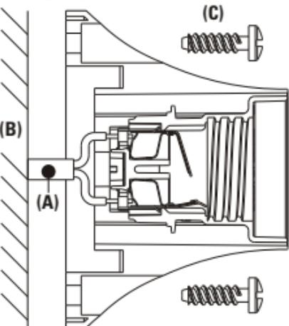
**[ITA] ISTRUZIONI DI MONTAGGIO** Spellare il cavo di alimentazione (A) secondo le dimensioni indicate (Fig. 1) e collegarlo ai morsetti a molla del portalampade (Fig. 2). Fissare l'apparecchio al plafone/parete (B) tramite 2 viti diametro 5 (C) (Fig. 2).
