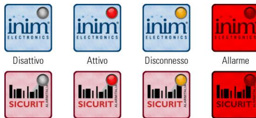
FIGURA 24. STATI POSSIBILI DI UN'AREA ANTINTRUSIONE INIM O SICURIT
