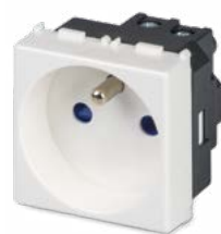
21177-AB Prise standard français 2P+T 16A 250V~, avec sécurité
