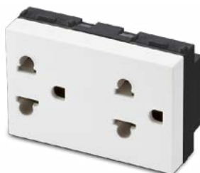
21188.3-AB Double prise 2P+T 16A 250V~ euro-américaine, 3 modules, avec sécurité
