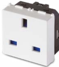
21178-AB Prise 2P+T 13A 250V~ standard britannique, avec sécurité
