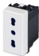
21159-AB Prise Italienne P17/11 2P+T 16A 250V~, avec sécurité
