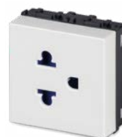
21188.2-AB Prise euro-américaine 2P+T 16A 250V~, 2 modules, avec sécurité
