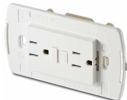
21184.3-AB Double prise 2P+T 16A 250V~ américaine avec disjoncteur magnéto-thermique différentiel, appareil con support et à compléter avec plaque 3 module
