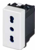
21159-AB Presa P17/11 2P+T 16A 250V~ bivalente, con sicurezza
