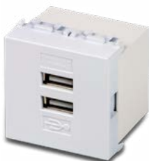
21213.2-AB Unità di alimentazione per dispositivi elettronici USB con 2 prese tipo A femmina, 5V 4A totali, alimentazione 100-240V~ 50/60Hz, 2 moduli, bianco
