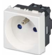
21177-AB Presa 2P+T 16A 250V~ standard francese, con sicurezza
