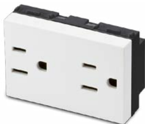
21186.2-AB Doppia presa 2P+T 15A 127V~ Americana, 3 moduli, alveoli non schermati
