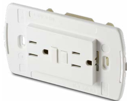
21184.3-AB Doppia presa 2P+T 16A 250V~ Americana con GFCI, supporto incluso. Da completare con placca 3 moduli.
