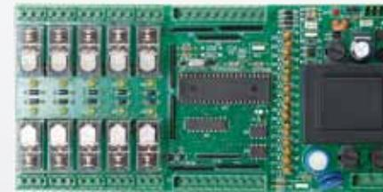
Eva Kit je sistem za upravljanje roletnama i prekidačima koji uključuje sve automatizme na jednoj ploči.
