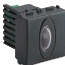
31466.2 Vészvilágítás, kétmodulos, világítási időtartam 12h, fényerősség 3cd, tápfeszültség 230V~, szürke
