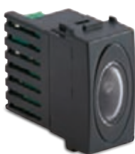
31466 Vészvilágítás, 1 modulos, világítási időtartam 12h, fényerősség 3cd, tápfeszültség 230V~, szürke
