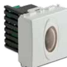
36466.2 SOLO 250V~ Indicador de emergencia 2 módulos, autonomía 12h, luminosidad 3cd, alimentación 230V~, blanco
