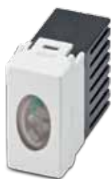
21465 SOLO 250V~ Lámpara de emergencia 1 módulo, autonomía 120', luminosidad 16cd, alimentación 230V~
