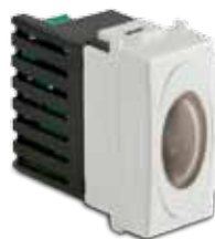
36466 SOLO 250V~ Indicador de emergencia 1 módulo, autonomía 12h, luminosidad 3cd, alimentación 230V~, blanco
