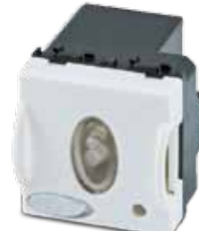
21462 SOLO 250V~ Lámpara de emergencia extraíble 2 módulos, autonomía 120', luminosidad 16cd, alimentación 230V con interruptor
