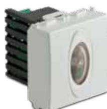
36465.2 SOLO 250V~ Lámpara de emergencia 2 módulos, autonomía 120', luminosidad 16cd, alimentación 230V~, blanco
