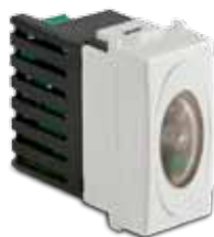
36465 SOLO 250V~ Lámpara de emergencia 1 módulo, autonomía 120', luminosidad 16cd, alimentación 230V~, blanco
