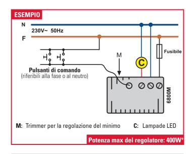
(\*) La potenza massima del Regolatore 6800M è di 400W. Per calcolare la potenza complessivamente applicabile è assolutamente indispensabile attenersi al declassamento indicato dal produttore delle lampade, e comunque massimo 100W di lampade.
