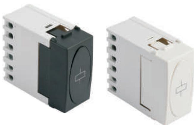
**U**na nuova opportunità nell'installazione delle serie civili Master. I relè da incasso ad un modulo offrono una nuova possibilità di recupero spazi e di utilizzo dei pulsanti anche in assenza di scatole di derivazione. La prima versione racchiude un relè passo-passo unipolare NA 10A con bobina a 230V. La seconda è costituita da un relè commutatore bipolare NA a 4 sequenze (AA-CC-AC-CA), sempre da 10A con bobina 230V. Entrambe le versioni sono già disponibili, sia per serie Modo che Mix.
