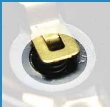
La nuova pastiglia: in evidenza i contatti con la molla di sostegno.
