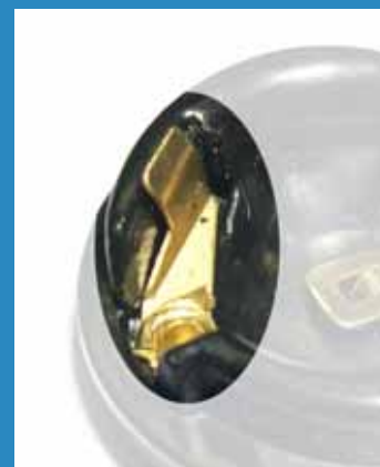
La nuova pastiglia: in evidenza i contatti con la molla di sostegno.
