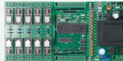
Eva Kit je sustav za upravljanje zastora i sklopki koja uključuje sve automatizme na jednoj ploči.
